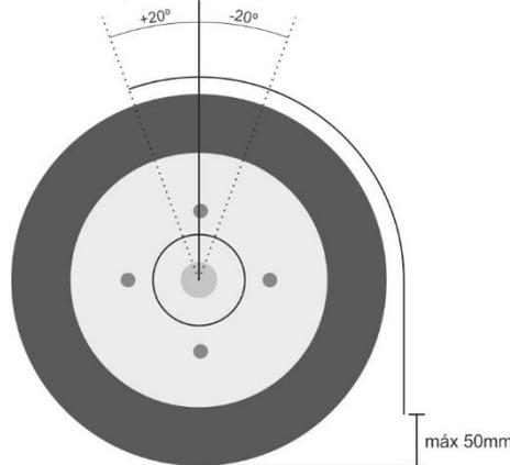
Figura 11 - Esquema de montagem dos guarda-lamas
