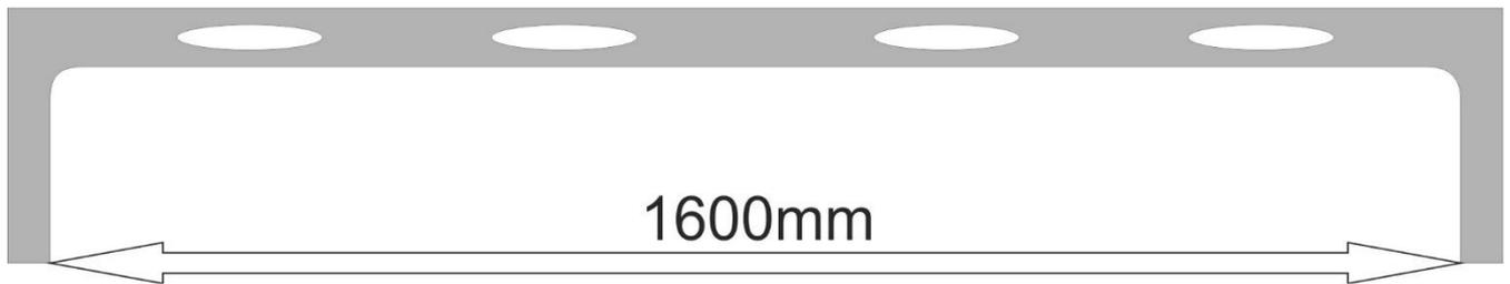
Figura 2 - Exemplo de bitola para verificação de largura
