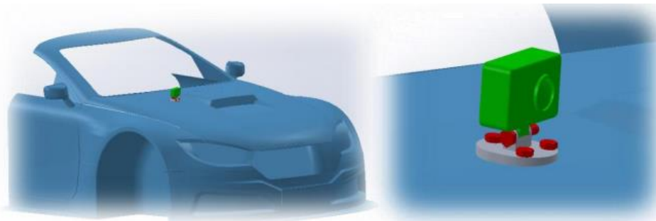
CÂMARA TIPO CAIXA, FIXADA SOBRE UMA SUPERFÍCIE, COM PARAFUSOS, PORCAS E ANILHAS
