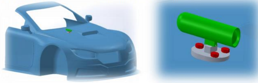
CÂMARA TIPO CILÍNDRICA FIXADA SOBRE UMA SUPERFÍCIE, COM PARAFUSOS, PORCAS E ANILHAS
