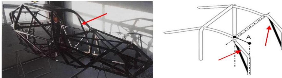
Figura 18 - Habitáculo / Reforço do montante do para-brisas
