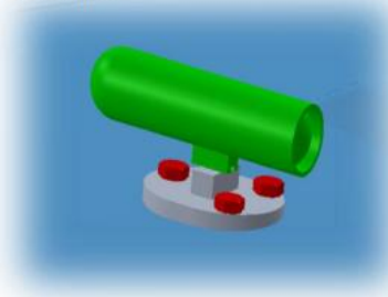
VISTA COM ZOOM: DETALHE DA CÂMARA TIPO CILINDRICO SOBRE UMA SUPERFICIE, FIXADA COM PARAFUSOS, PORCASE ANILHAS
