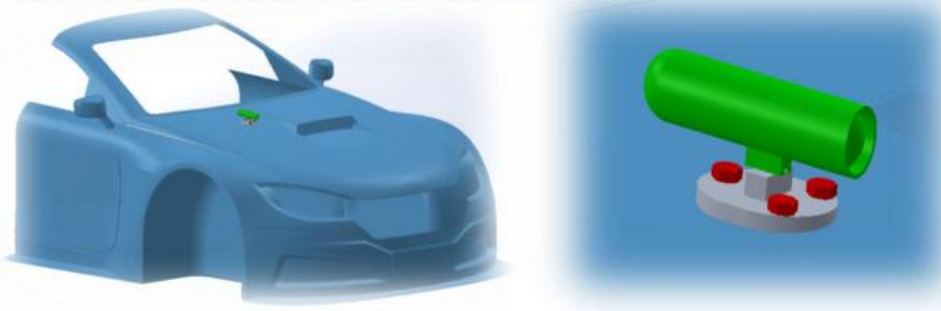
CÂMARA TIPO CILÍNDRICA FIXADA SOBRE UMA SUPERFÍCIE, COM PARAFUSOS, PORCAS E ANILHAS
