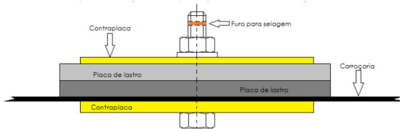
Cada parafuso deve ter uma contraplaca com superfície de contacto mínima entre a carroçaria/chassis de 40cm<sup>2</sup>.
