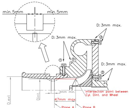
O restritor na zona do anel de restrição não poderá ter mais de 3mm de espessura, sendo o seu diâmetro exterior de:
